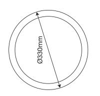
Diameter : Ø 330 mm Overall Depth : 79 mm
